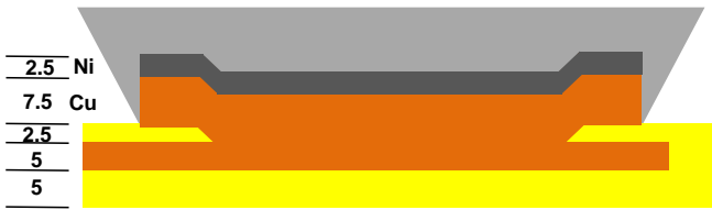
b. Stack up 1. Dimensions in (um).
